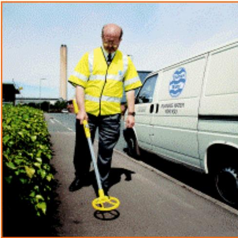
Elcometer P500 Imp 阀门室探测器
