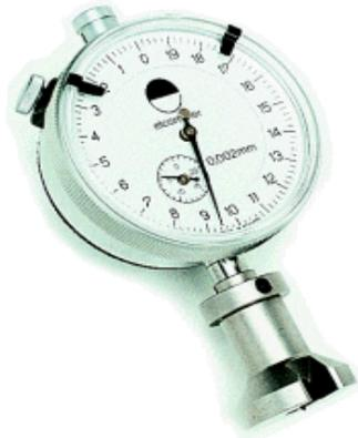
Elcometer 123 Mechanische Profilmessuhr
