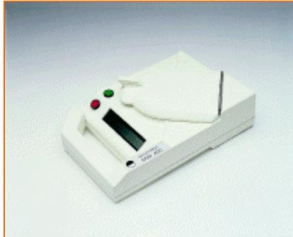
Elcometer 130 SCM400 Salz-Verunreinigungs-Messgerät
