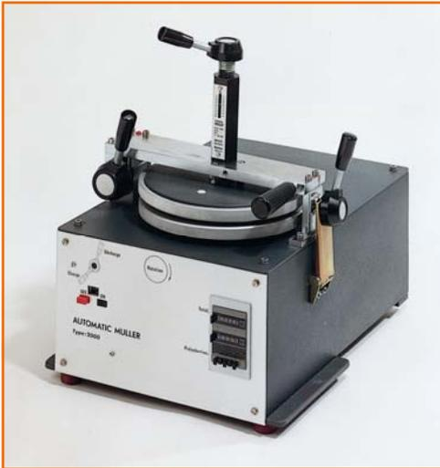
Elcometer 2000 Müller Labormahlmaschine
