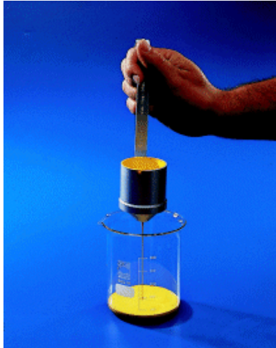
Elcometer FRIKMAR Tauchbecher mit Henkel
