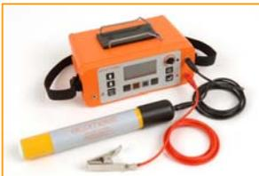
Elcometer 331<sup>2</sup> mit Halbzelle
