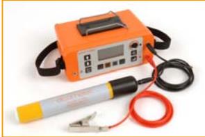
Elcometer 331 2 mit Halbzelle und Messwertspeicher
