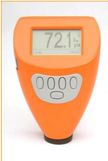
Elcometer 415 Schichtdickenmessgerät
