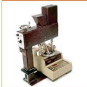
Es sind zwei Ausführungen erhältlich: das Modell 155 (s. Bild) und das Modell 255. Das Modell 155 verwendet eine Ausrichtungsleitspindel um die Zuführvorrichtung in die richtige Position zu bringen. Die Höhe der Strahlmittelführung und der Ansaugdüse können über eine Flügelschraube justiert werden. Um sicher zu gehen, dass die Zuführvorrichtung richtig platziert ist, wurde beim Modell 255 ein Ausrichtungsblock mit dem Geräteboden verbunden.
