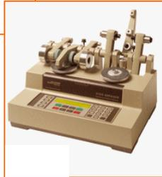
Taber® 5135 & 5155 rotierendes Abriebprüfgerät
