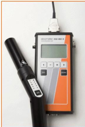
Elcometer 550 II Berührungsloses Pulverdicken-Messgerät
