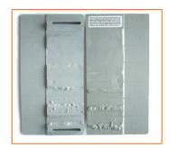
Die Elcometer Vergleichsscheibe für Schweissnähte ermöglicht erstmalig einen qualitativen Vergleich von Schweissnähten.
