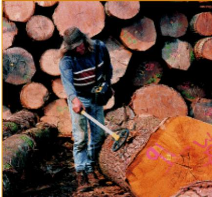
Elcometer P610 Metallsuchgerät für Holz
