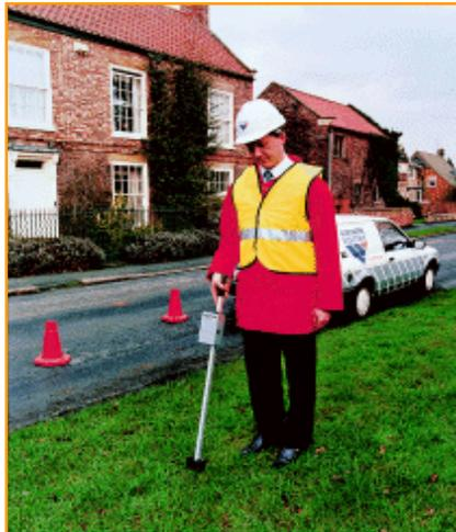
Elcometer P700 Leitungssuchgerät
