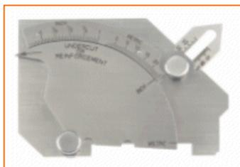
El medidor de soldaduras Elcometer 147 mide diferentes aspectos de las soldaduras en unidades métricas e imperiales e incluye:
