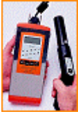
Medidor de espesor de polvo sin curar y de no contacto Elcometer 550*
