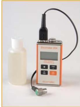
Medidor de Espesor Ultrasónico de Acero
