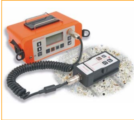
Medidor de cobertura de hormigón con media celda Elcometer 331 2
