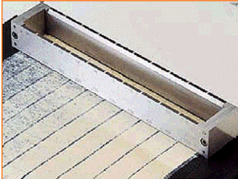
Aplicador de película cuádruple de hundimiento Elcometer 4290
